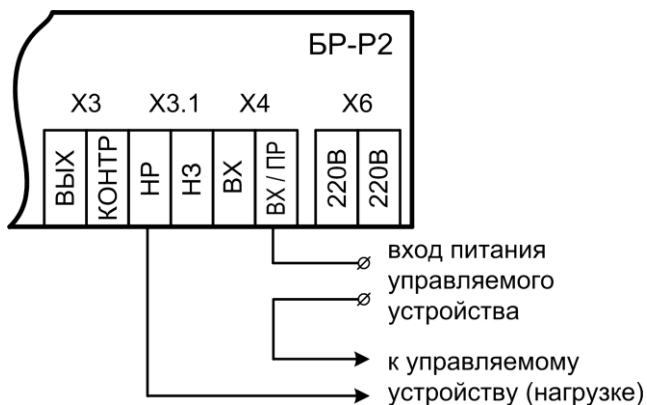
Рис.22 Схема подключения для функциональной проверки работоспособности БР-Р2
