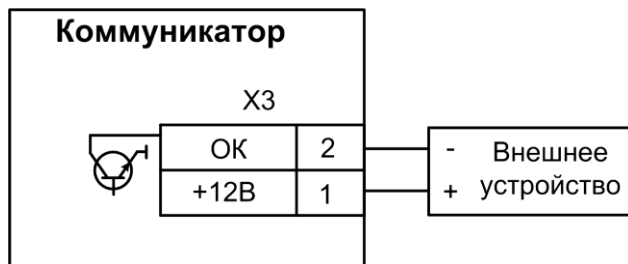
Рис.27 Схема подключения внешнего устройства к коммуникатору
